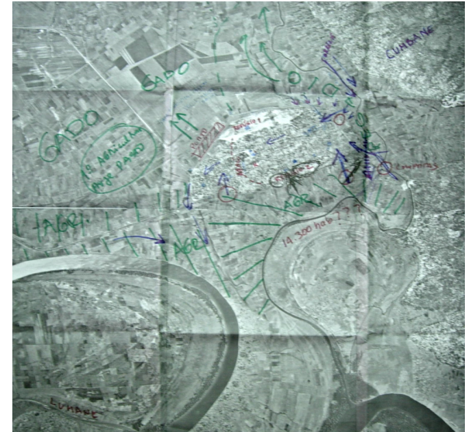
Figura 9: Exemplo de um mapeamento expedito directamente na fotografia aérea
