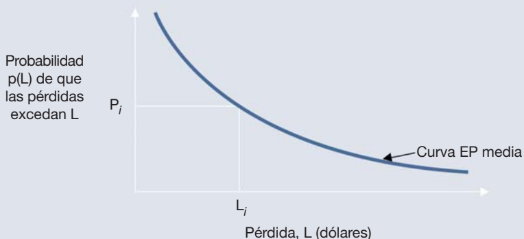
Figura del cuadro 3.1 Ejemplo de una curva de probabilidad de superación (EP)
