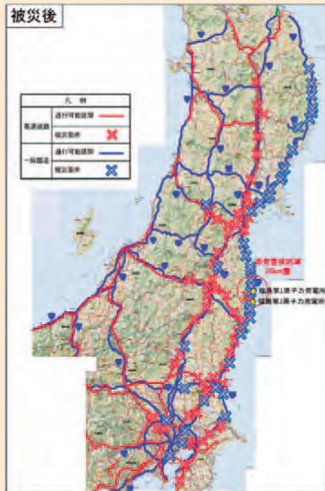
図2：地震直後の高速道路と国道の状況、
