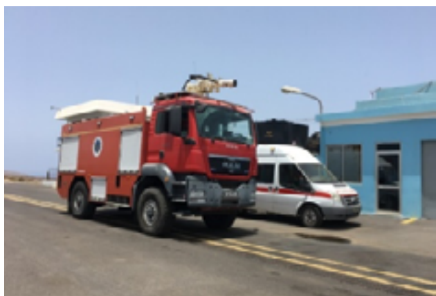
Imagem 22: Camião RIV-Fire com monitor de teto controlado por manivela nos aeroportos de Fogo (e) e São Vicente (d).
