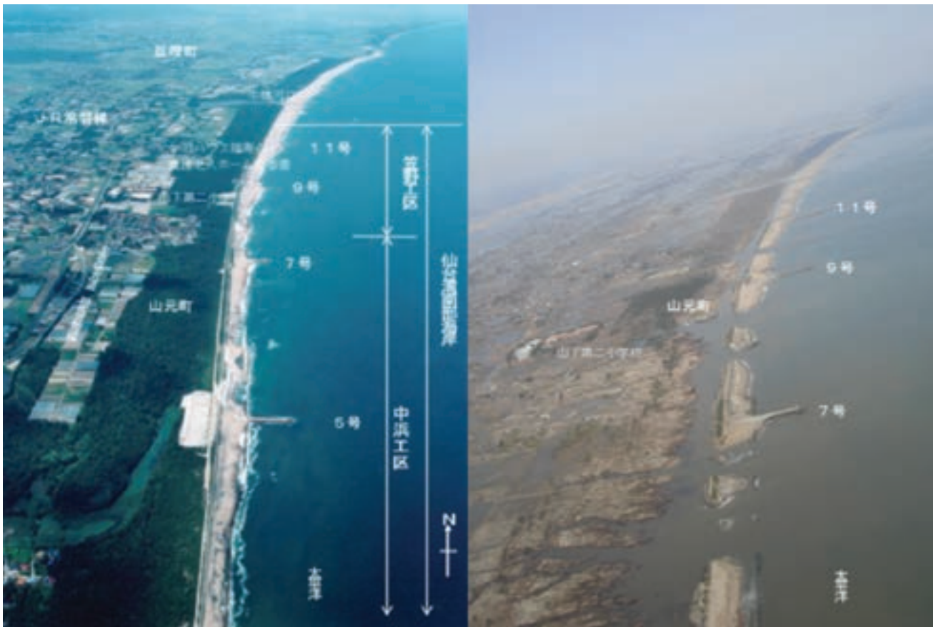
図0.3 仙台平野で被災した堤防：震災前（左）と震災後（右）
