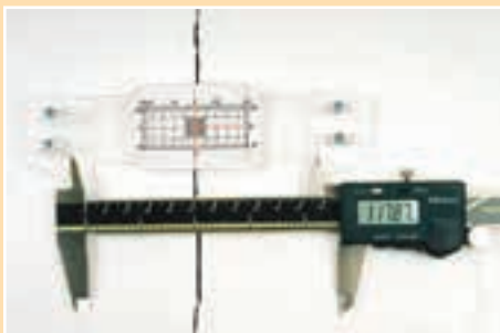
FIGURA 9.21 Medidor de control de grietas y gráficos de registro de grietas
