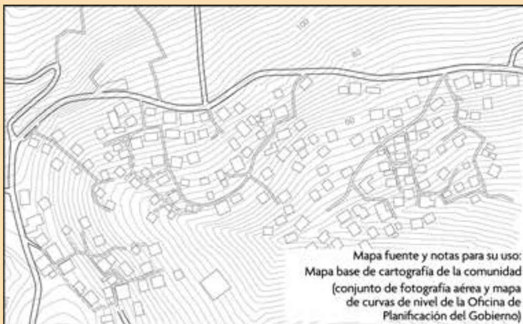
FIGURA 4.6 Generar el mapa base a partir de un mapa topográfico y una fotografía aérea
