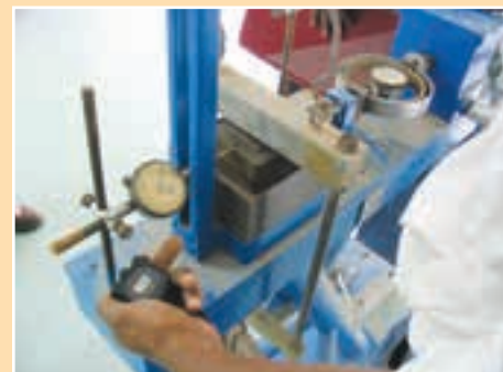
FIGURA 3.20 Caja de corte utilizada para determinar los parámetros de dureza del suelo
